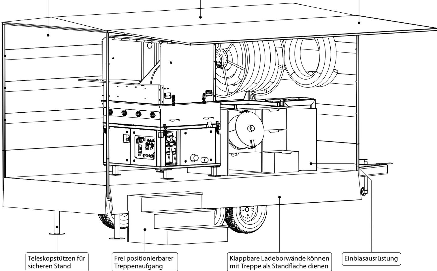
Teleskopstützen für sicheren Stand
