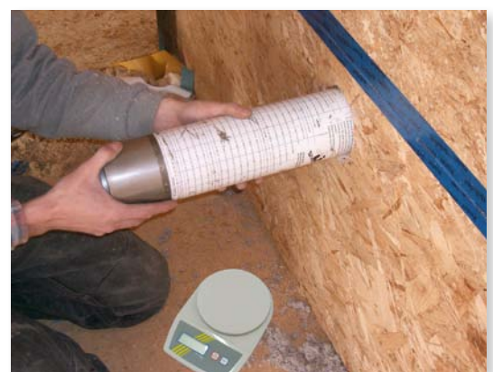
Dichteprüfung an einem Wandelement
