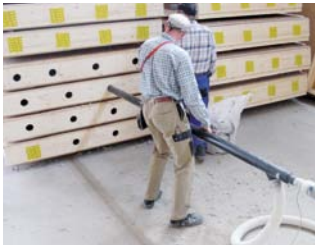
Befüllen von Holzelementen mittels Einblaslanze mit aktiver Absaugung
