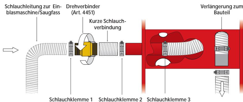
Der Drehverbinder stellt die vollständige Funktion der Schlauchtrommel her und ermöglicht dem Einblasteam optimierte Baustellenabläufe.
