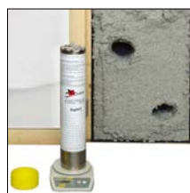
Dichteprüfung am befüllten Prüfelement mit Dichtepferset NW100
