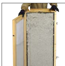
Öffnen des Prüfelement und begutachten des Befüllergebnisses
