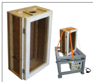
Prüfelement zur Prüfung von sämtlichen Einblasverfahren
