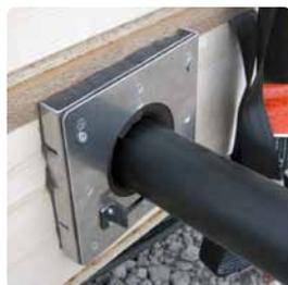
Einblaslanze mit Manschette für Elementbefüllung
