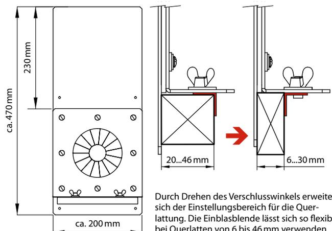
Durch Drehen des Verschlusswinkels erweitert sich der Einstellungsbereich für die Querrattung. Die Einblasblende lässt sich so flexibel bei Querratten von 6 bis 46 mm verwenden.
