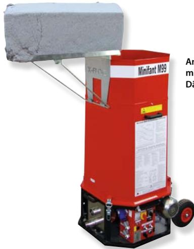
Angesteckte Sackauflage mit aufgelegtem Dämmstoffgebände
